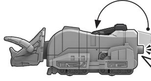
・図のようにジョイントを引き出して、元に戻してください。
